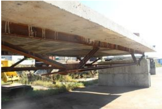
Рис. 3. Натурна комбінована сталезалізобетонна попередньо напружена шпренгельна конструкція
