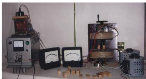
Рис. 7.1. Общий вид экспериментальной установки для обработки образцов в постоянном магнитном поле
