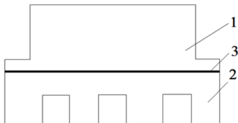
Рис. 16.2 Схема крепления электронного прибора. 1 – прибор; 2 – радиатор; 3 – контактный переход.
