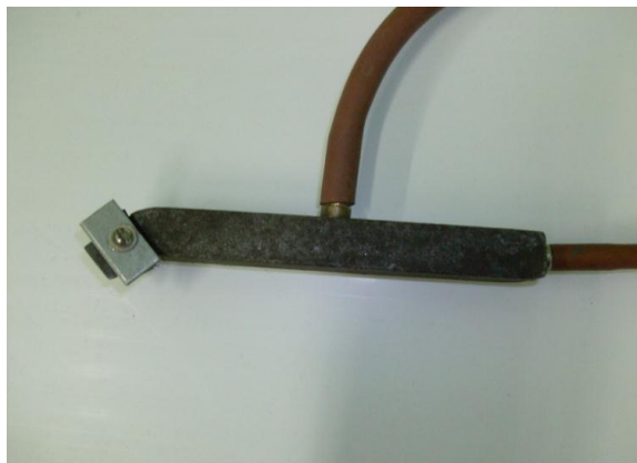
Рис. 16.3 Сборный токарный резец с механическим креплением ножа-вставки и внутренним охлаждением. 1 – державка резца; 2 – зона контакта ножа с державкой; 3 – нож-вставка
