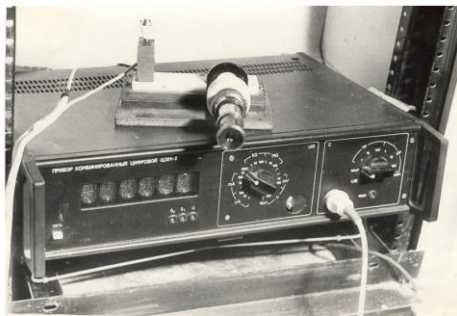
Рис. 9.4. Общий вид установки для определения внутренних напряжений в клеевых прослойках
