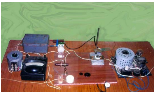
Рис. 8.1. Общий вид высоковольтной установки для обработки образцов в постоянном электрическом поле
