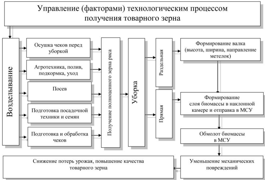
Схема управления технологическими процессами возделывания и уборки риса
