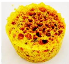
Рисунок 3 – Образец VI, получен взаимодействием 7 частей фенола и 3 частей уротропина. Мощность 500 Вт, время 2 минуты
