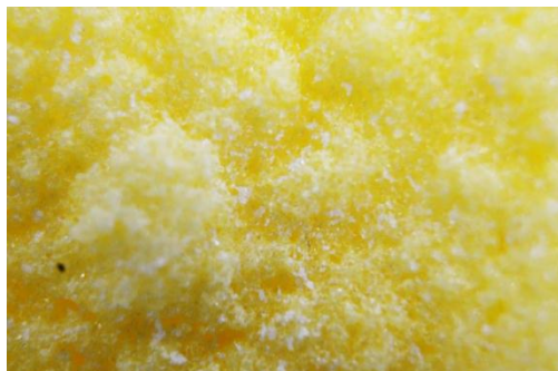
Рисунок 6 – Образец IX, получен взаимодействием 4 частей фенола и 6 частей уротропина. Мощность 500 Вт, время 4 минуты
