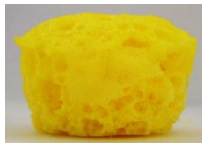
Рисунок 4 – Образец VII, получен взаимодействием 6 частей фенола и 4 частей уротропина. Мощность 500 Вт, время 3 минуты
