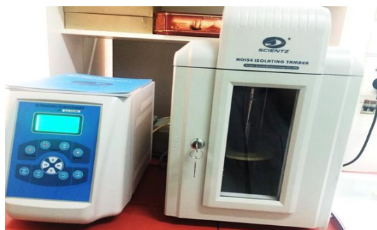
Рис. 2 – Ультразвуковая установка Ultrasonic Homogenizer
