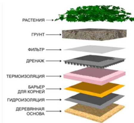
Принципиальная схема устройства «зеленой крыши»
