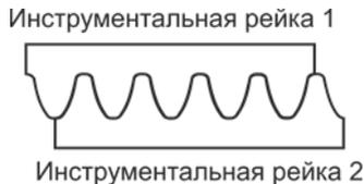
Рис. 1. Инструментальные рейки с обратными профилями боковых поверхностей зубьев
