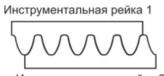
Рис. 1. Инструментальные рейки с обратными профилями боковых поверхностей зубьев
