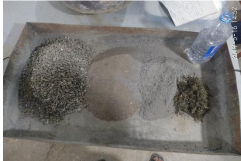
Рис.4 Компоненты для приготовления бетонной смеси
