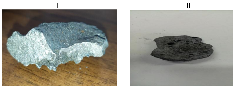
I-ферросплав; II-карбид кальция Рисунок 4. Продукты плавки
