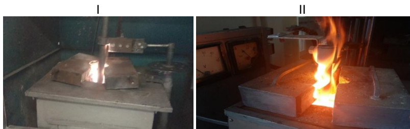
I-середина электроплавки; II-окончание электроплавки Рисунок 3. Фрагменты электроплавки шихты
