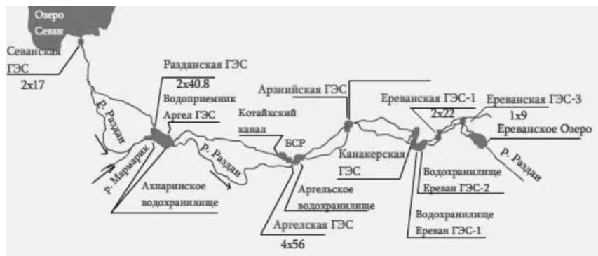
Рис.2. План гидротехнических сооружений каскада ГЭС Севан-Раздан
