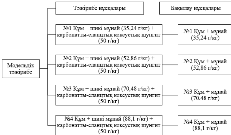
1-сурет. Каспий теңізінің жағалау аймағындағы мұнаймен ластанған құмды биоремедиациялау бойынша үлгі экспериментінің нұсқалары (тәжірибе және бақылау) және эксперименттер (№ 1-4)
