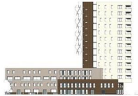
Նկ.2. Լոնդոնի Ռամսգեյթ Սթրիթում Waugh Thistleton ընկերությանը պատկանող բնակելի շենքի նախագիծ ա-ընդհանուր տեսք, բ-հարկի հատակագիծ, գ-հողմահար տուրբին, դ-հողմահարների դիրքը ճակատում
