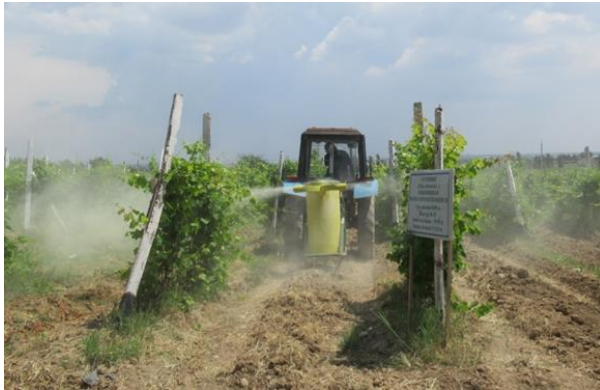
Рис. 1 Опыливатель ОШУ-200М в агрегате с трактором Беларусь 82.1 в работе (вид сзади).
