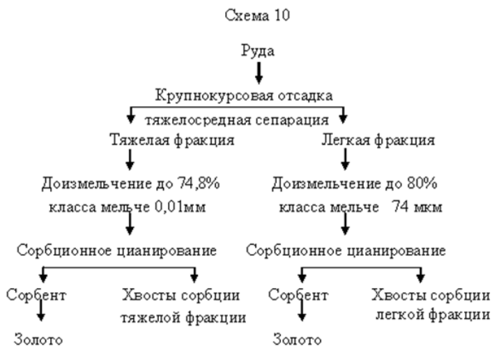
Рисунок 18 - Схема переработки руды крупнокусковой отсадкой и цианирование легкой и тяжелой фракций
