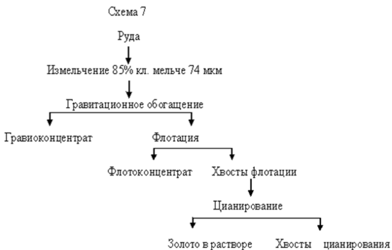
Рисунок 15 - Схема переработки руды отсадкой, флотацией и цианированием хвостов флотации
