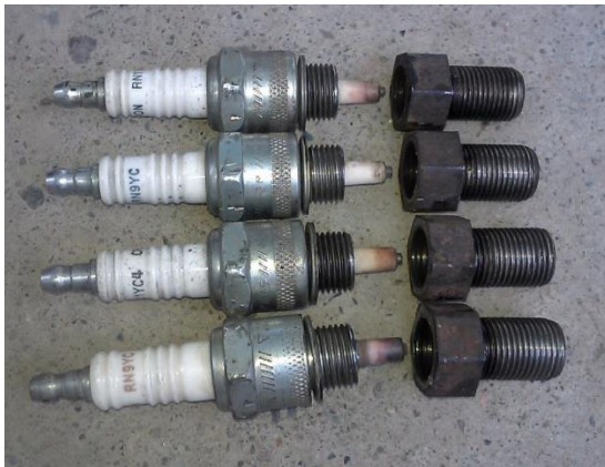
Рис. 4. Изготовленные свечи зажигания с соплом Лавалья
