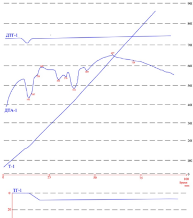
2а-расм. Исмоил Самоний мақбараси деворнинг пастки қисмидан олинган намунанинг (1С) ДТА натижаси
