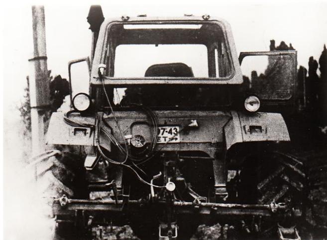
Рис.2.5 Аллонжи, установленные в зоне заливной горловины топливного бака
