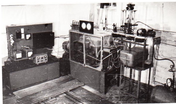
Рис.3.5. Общий вид стенда для исследования процессов накопления и очистки от загрязнений топлива в дизельной топливной аппаратуре
