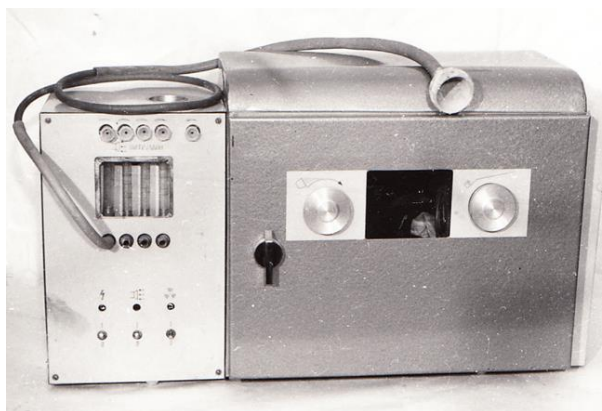
Рис.3.10 Прибор для определения концентрации пыли в термокамере
