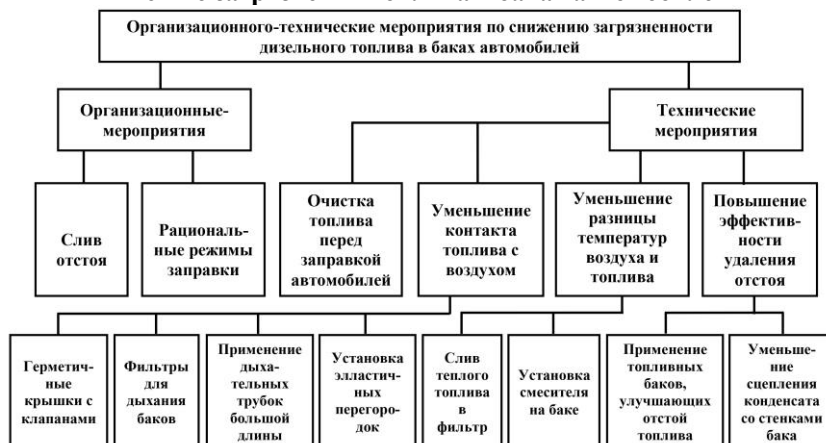
Рис.4.1. Схема организационно-технических мероприятий по снижению загрязнения топлива в баках автомобилей
