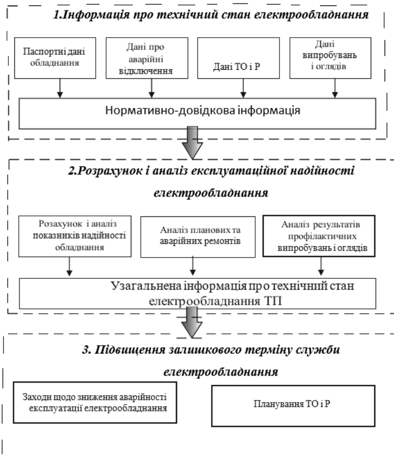
Рисунок 11.5 – Структура системи збору та обробки інформації ІСМД ТП
