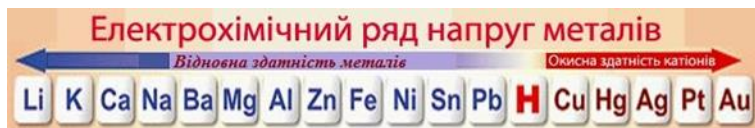
Рисунок 6.1 – Електрохімічний ряд напруг металів
