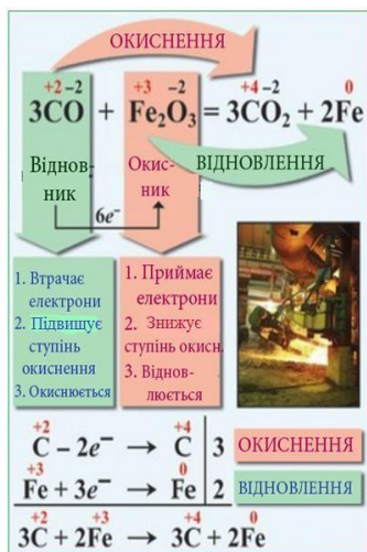
Рисунок 5.1 – Процеси окиснення та відновлення.
